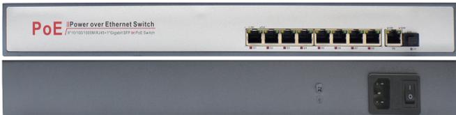
PSW8-BT系列是全千兆bt PoE交换机,具备9个10/100/1000M 自适应RJ45端口+ 1个1000M SFP光口插槽,其中1-8口支持超大功率71W POE输出,并且向下兼容IEEE 802.3af/at PoE标准,单端口PoE功率高达95W。
