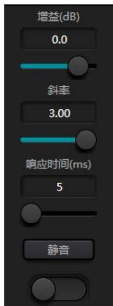
最下面的按钮打开或关闭自动混音的功能
