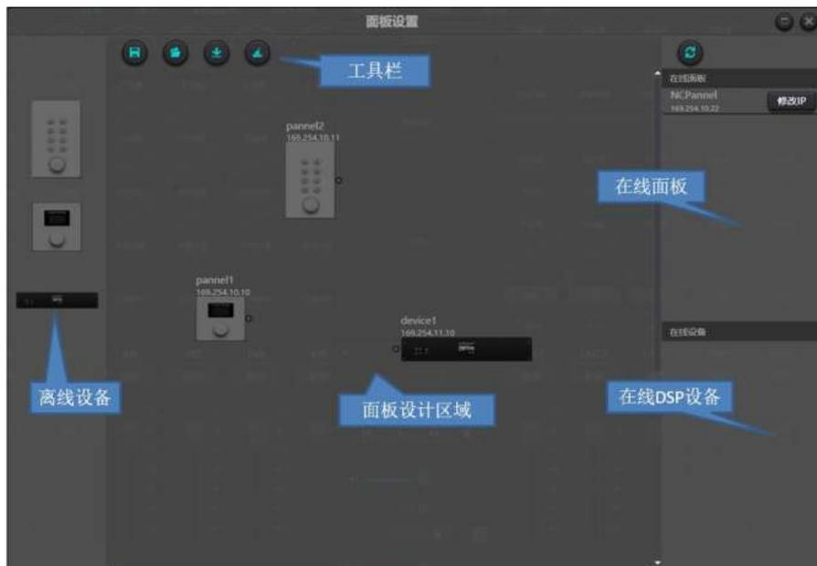
离线设备：适用于离线编辑状态，调试工程师先在本地配置好面板参数，然后下载到在线的面板中。当然也可以直接编辑在线面板的，在在线面板那一栏中拖出到面板设计区域双击编辑。
