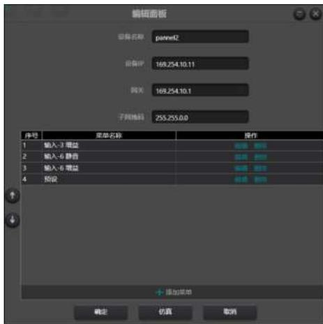
点击添加菜单，弹出菜单选择框，选择对应的菜单项，确定即可。软件菜单配置完成后，点击工具栏的下载图标，将配置下载到面板硬件中。
