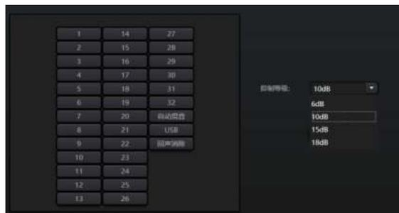
**抑制等级：**共有 6、10、15、18dB 四种类型可选。dB 的含义是抑制噪声降低多少 dB，值越大，对语音的伤害也越大，这是无法避免的。
