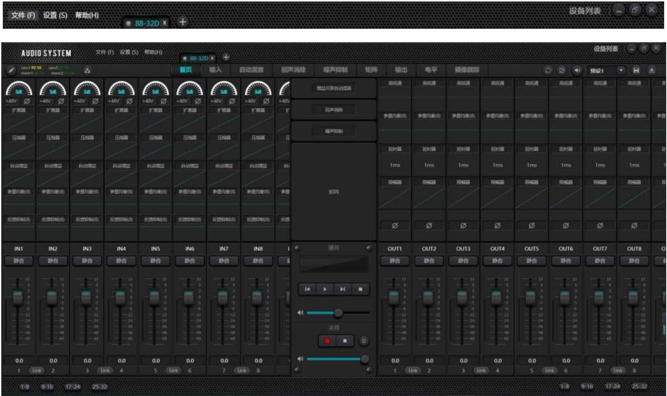
点击主界面的右上角 **设备列表** 按钮，会自动查找网络上所有的处理器，用户根据需要连接到指定的处理器，联机后连接指示灯会闪烁，一台处理器最多支持 8 个用户同时在线连接和控制。
