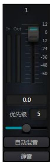
**自动混音：**每一个通道都有一个自动混音开/关按钮，需要参与自动混音的通道要开启该按钮。也可将其关闭，该通道不参与自动混音。
