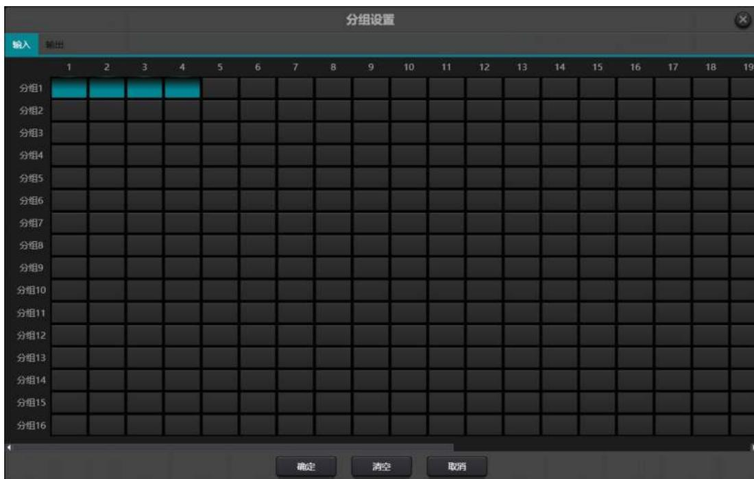
每一个分组可选择 1-设备最大通道数。设备最大通道数取决您购买的型号而定。通道设置成一个分组，在主界面该分组将以一个颜色区分。
