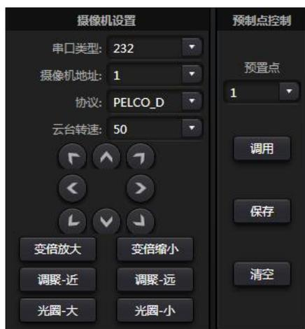
首先进行串口设置，串口有 2 个(232、485)，与云台所连接的后背板端口对应；
