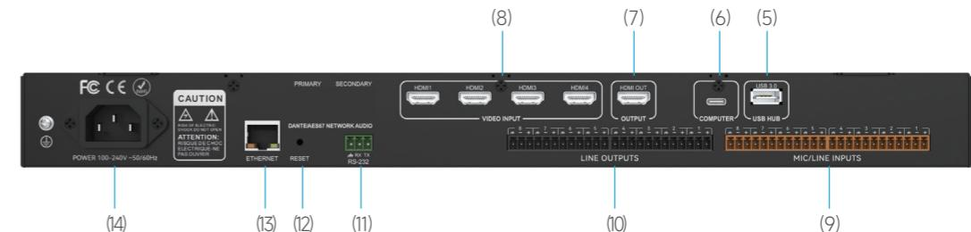
(5) USB3.0 HUB: 可接入USB麦克风、USB摄像头，将其信号分配至Type-C
